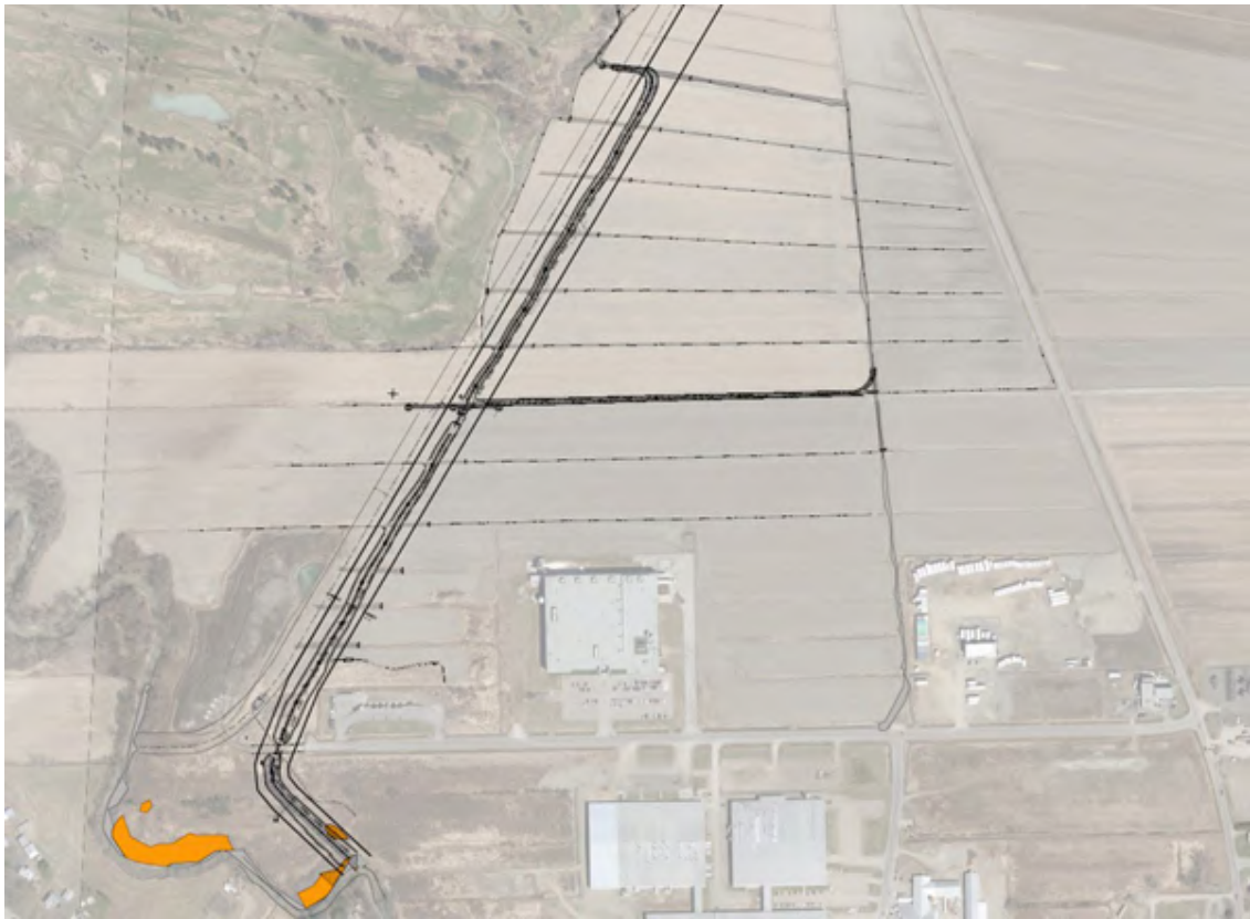
Tracé de la déviation du cours d'eau Grande Décharge dans le Parc industriel régional de la MRC
